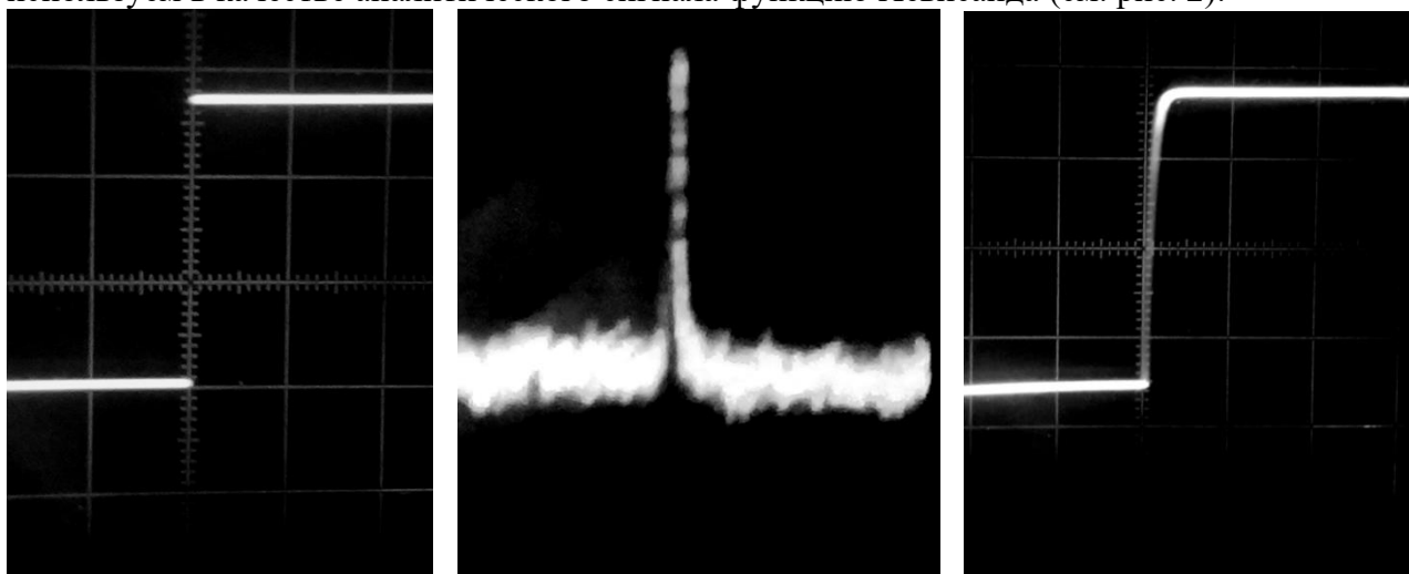
Рис.2. Слева – сигнал Хевисайда, подаваемый на гидроакустический излучатель, в центре – потенциал Дебая U=20 мкВ, справа – поворот вектора Джонса (все снимки с экрана осциллографа).
